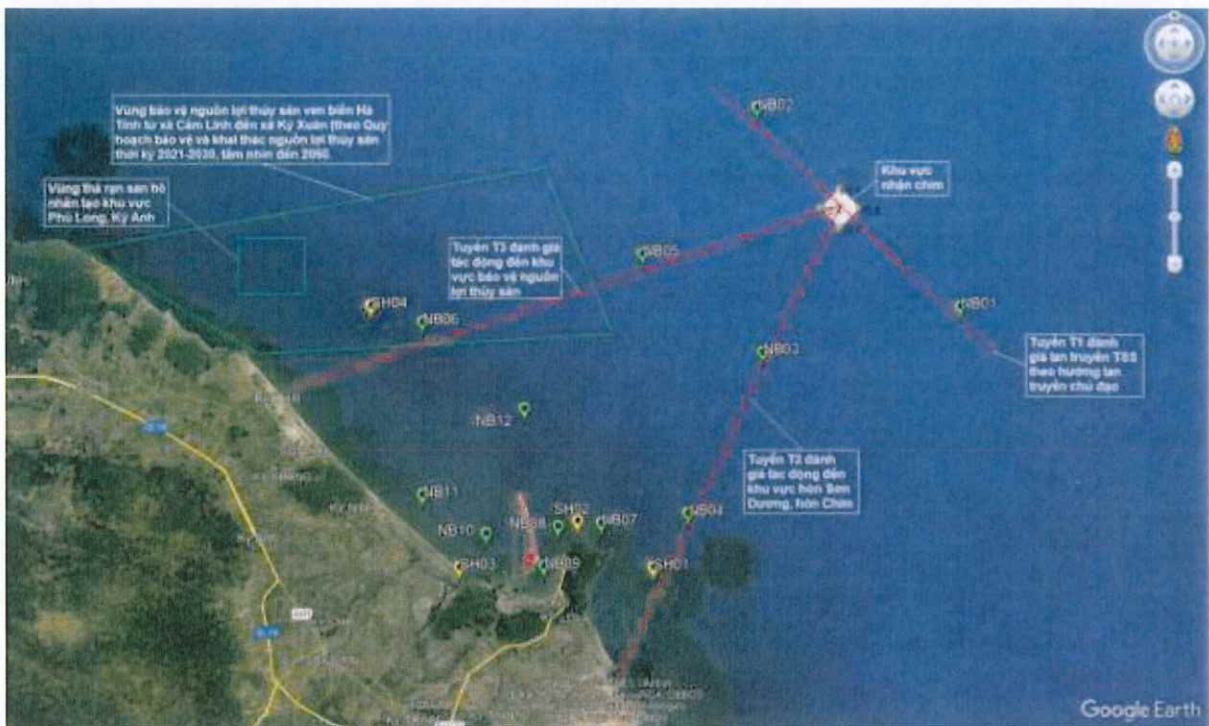
Hình 5.1. Sơ đồ vị trí giám sát nước biển khi thi công nạo vét, nhận chìm
