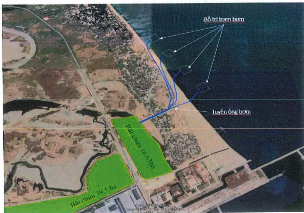
Hình 1.15. Minh họa mặt bằng bố trí các trạm bơm, tuyến đường ống
