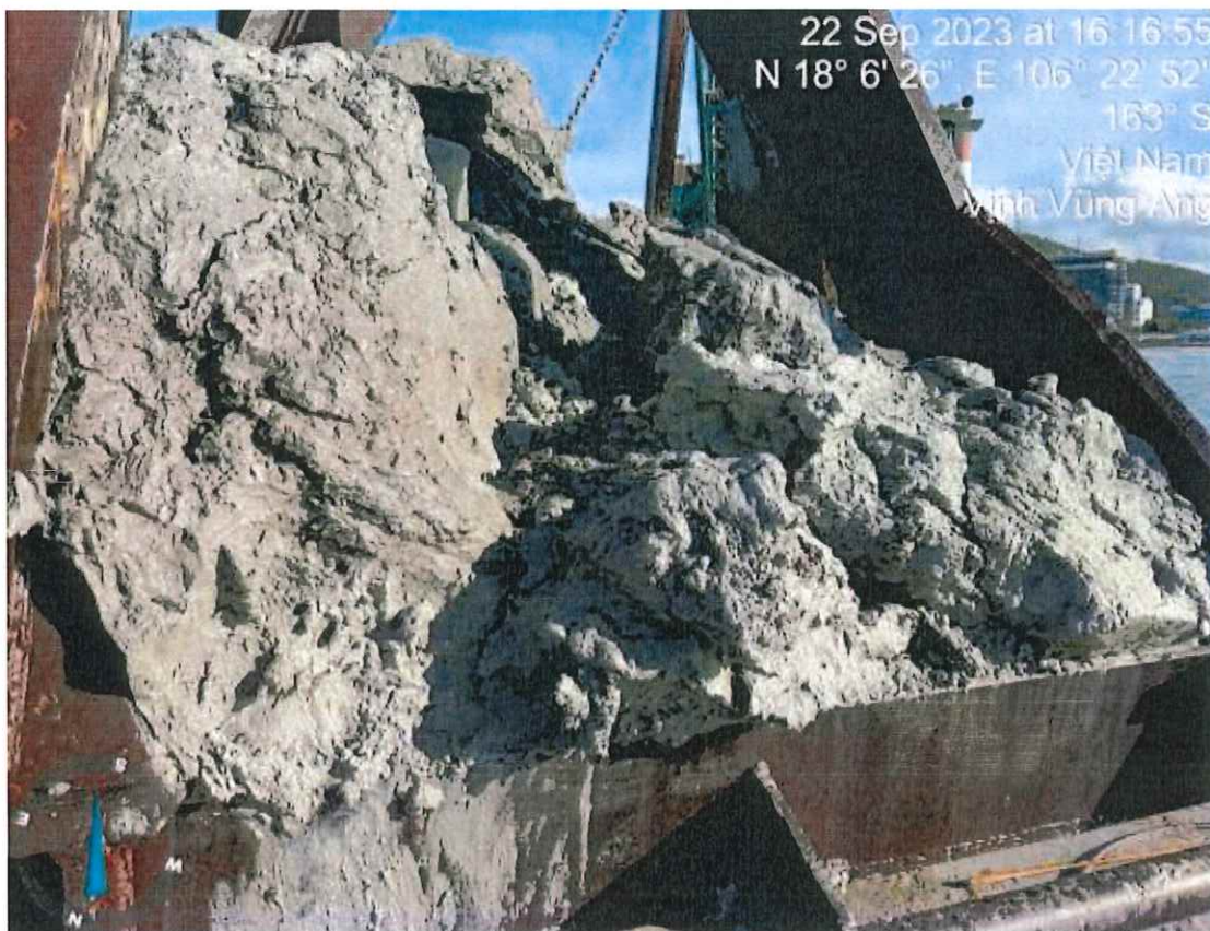
Hình 2.19. Kết quả kiểm tra thực tế vật liệu nạo vét tại khu vực cửa nhận nước chiều 22/9/2023
