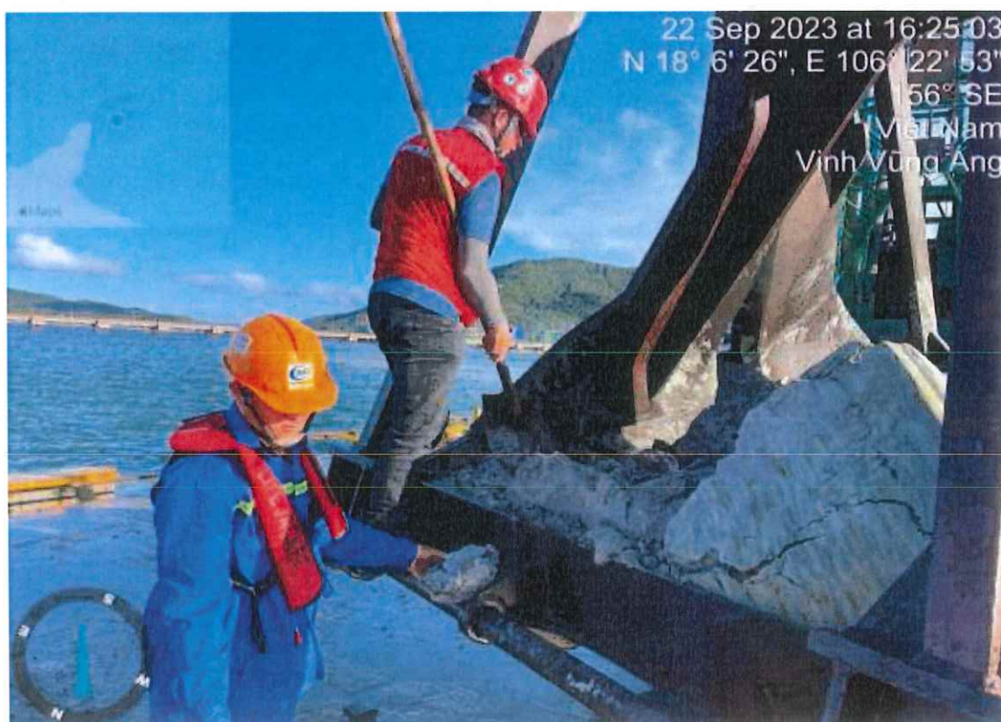
Hình 2.20. Kết quả kiểm tra thực tế vật liệu nạo vét tại khu vực cửa nhận nước chiều 22/9/2023
