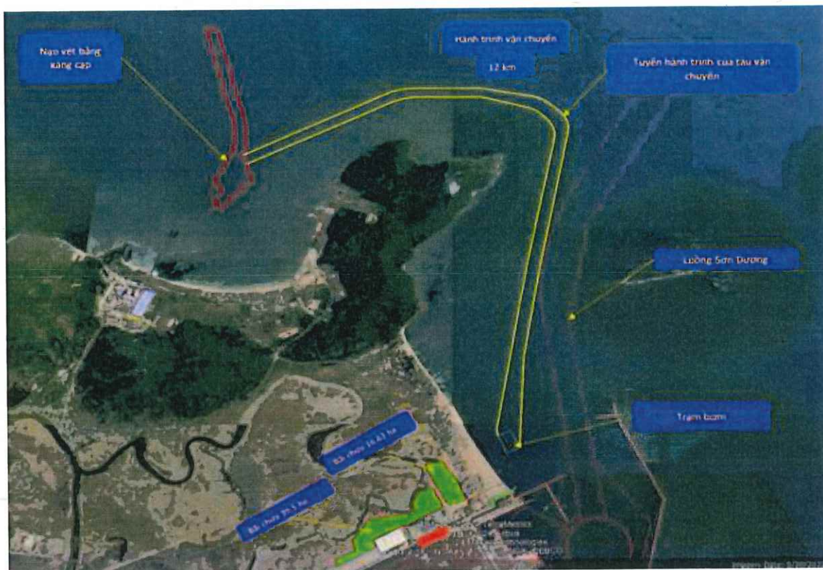
Hình 1.14. Minh họa tuyến vận chuyển chất nạo vét từ khu vực nạo vét đến vị trí các trạm bơm (khoảng 12km)
