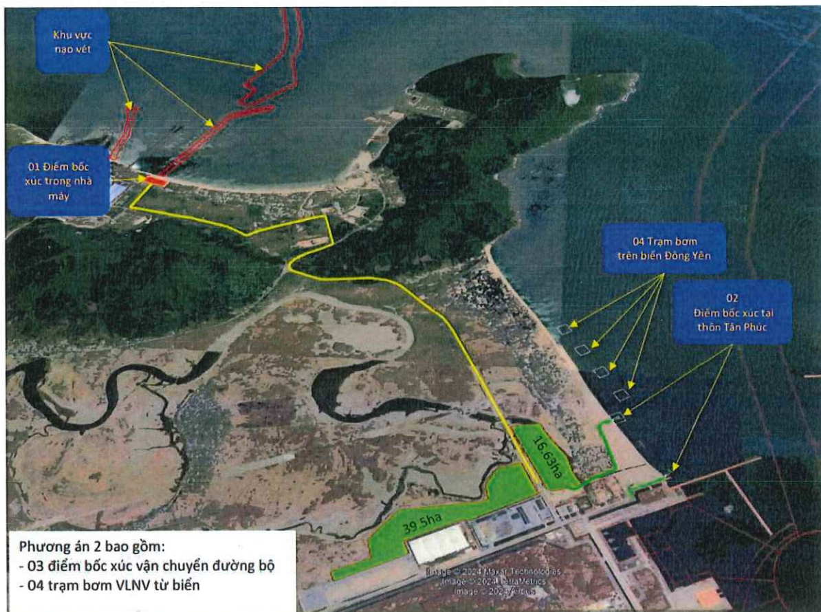
Hình 1.2. Sơ đồ mô tả bố trí mặt bằng các vị trí trạm bơm và trạm trung chuyển
